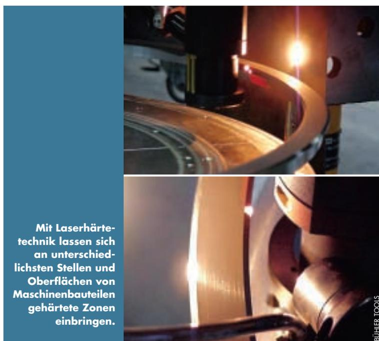
Mit Laserhärte-technik lassen sich an unterschiedlichsten Stellen und Oberflächen von Maschinenbauteilen gehärtete Zonen einbringen.
