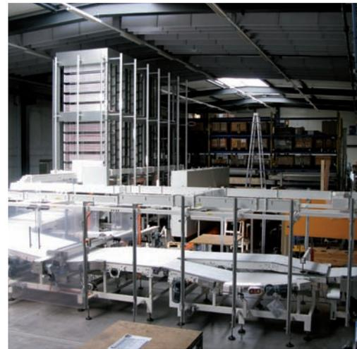
Aufbau einer Verpackungslinie mit Produktflussregulator (Produkte Puffer).
