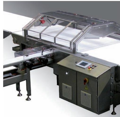
Austragestation zur Förderung einzelner Schokolade- oder Biskuitreihen aus einem Produktfluss zur Beschickung einer Verpackungsmaschine.
