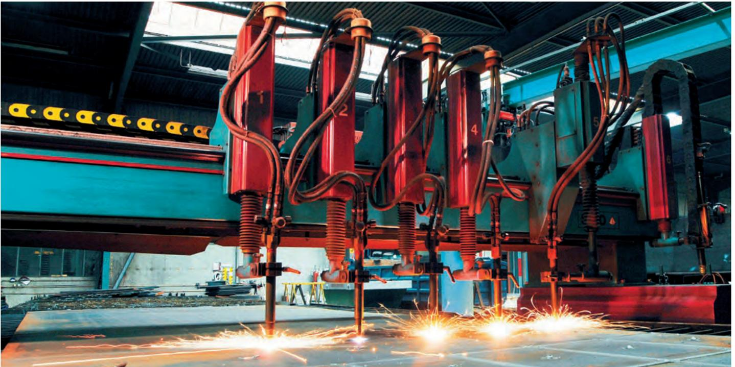
eNventa ERP unterstützt die FF Group auch bei Fertigungsprozessen; im Bild die Autogene Brennschneidanlage Typ Sato.
