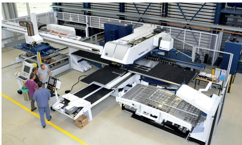
In der Smart Factory der Hans Eberle AG ist die neueste Generation Stanz-/Lasermaschinen direkt ins IN:ERP integriert und ermöglicht so eine dynamische Anpassung an Kundenwünsche.
